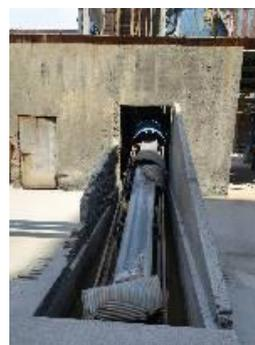
（1）煤炭装卸过程中开启水雾炮抑尘，传送带加盖；
