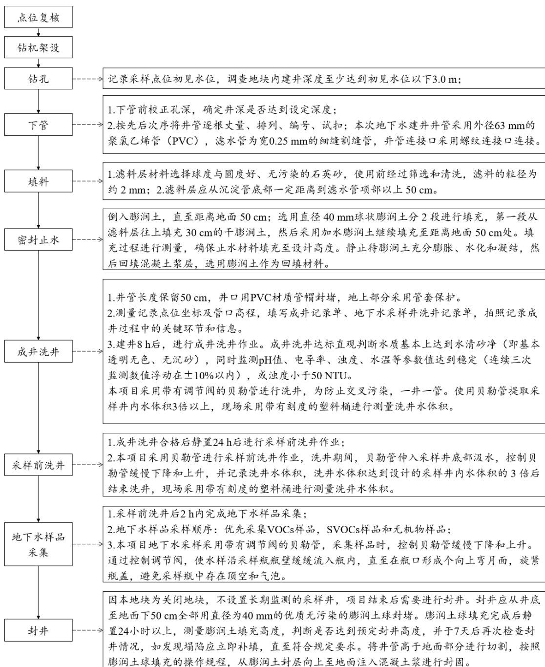
图 3.4-1 地下水监测井建设及采样流程
