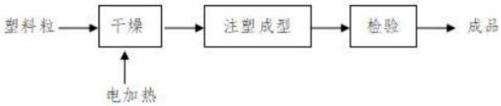
图 2.4-3 连接器生产工艺流程及产污节点图
